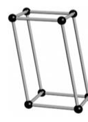
Triclinic a \neq b \neq c \alpha \neq \beta \neq \gamma
